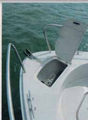
L'immense capacité de rangement à bord du nouvel open du chantier Acroplast comprend une très grande soute sous le pont avant et une belle baille à mouillage.
