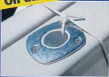
La présence de cadènes pour fixer les défenses plutôt que de devoir utiliser les porte-cannes.
